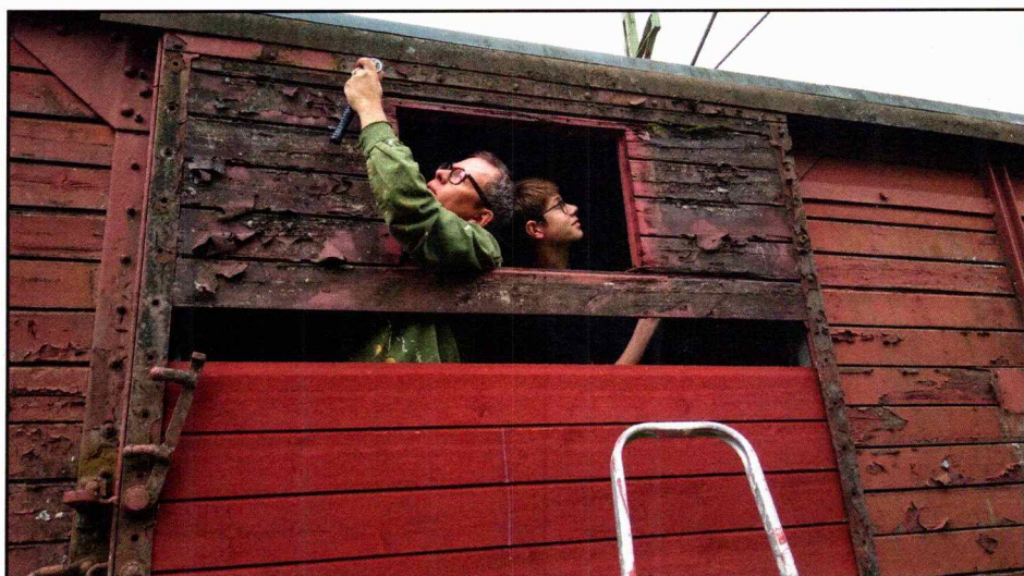
Martin och Benjamin demonterar gammal panel på Gsh 31300. Foto Dan C.
