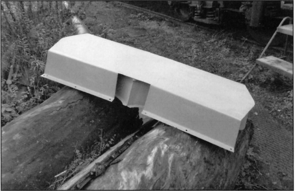
Ventilationshuv till RCo1.
