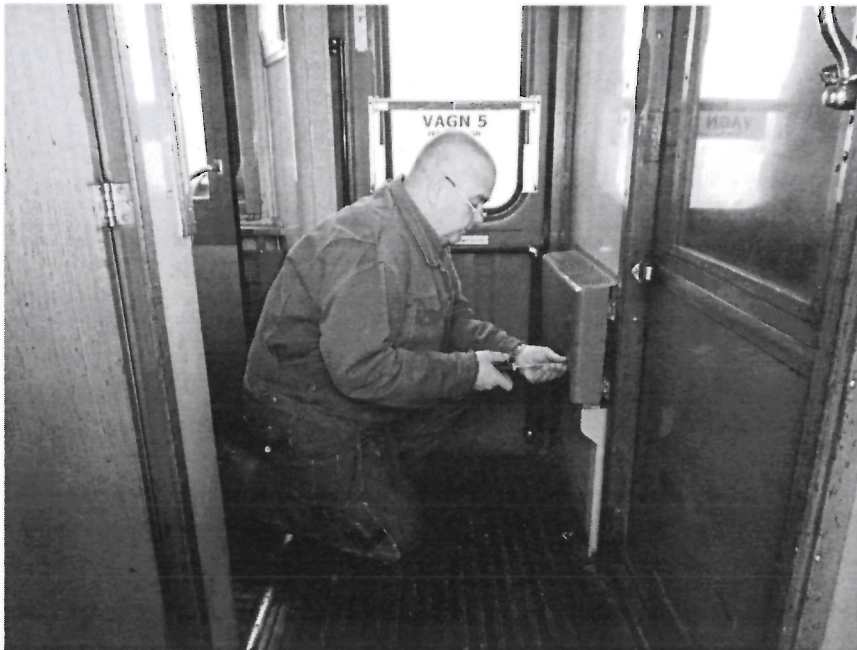
Dan lossar ett elementskydd i en Co&d vestibul.
