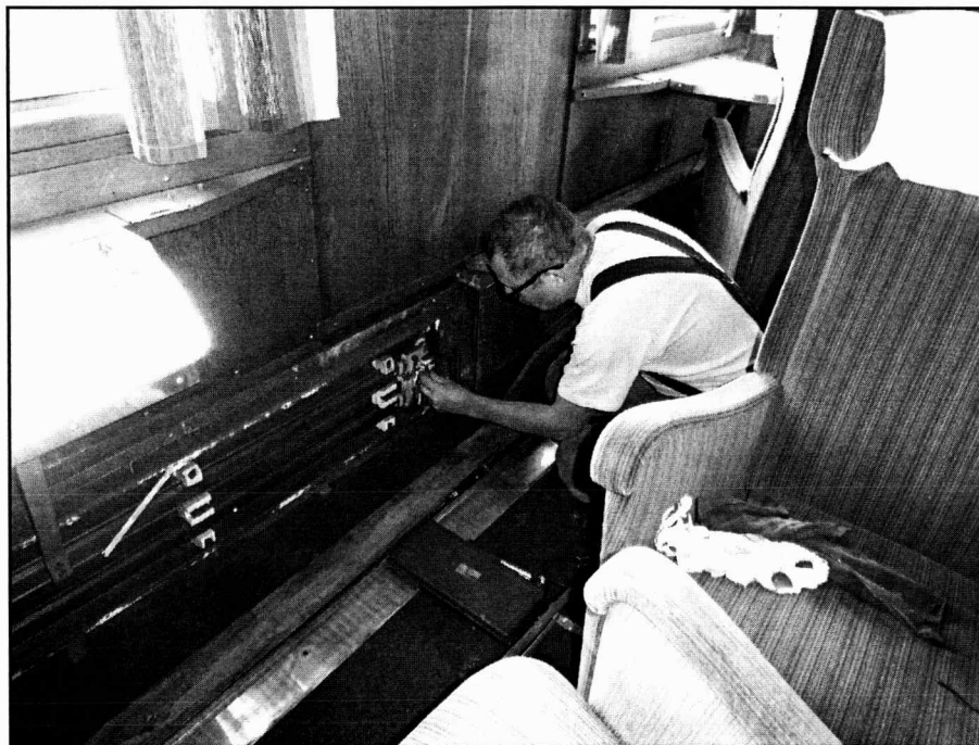
Martin utför elementtillsyn i Bo5b.
