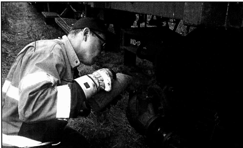
Martin fyller olja i en axelväxel.
