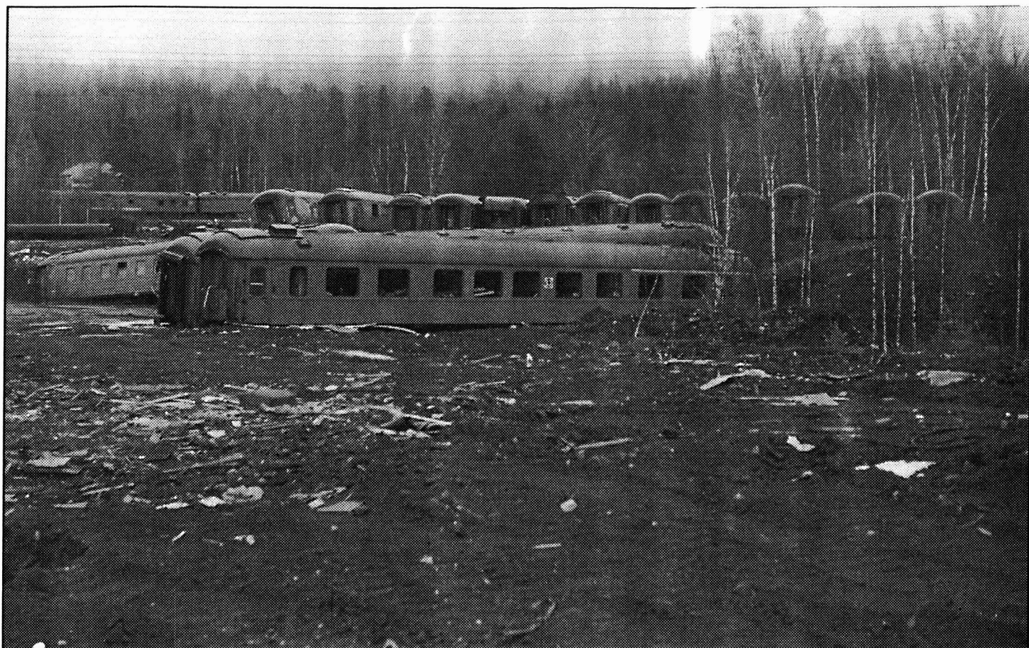
Minst 18 vagnar på samma bild och flera fims dolda i buskar och snår. Här står vagnar uppställda i väntan på den slutgiltiga skrotningen. Boggierna har plockats bort och skall fraktas tillbaka till SJ. Foto: samtliga i Nykroppa, Urban Lavén.
